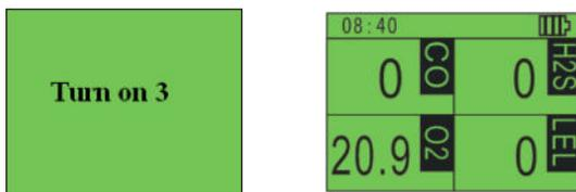
**Примечание:** при самопроверке зуммер издает звук 3 раза, светодиоды загораются 3 раза, и вибрация включается 3 раза.
