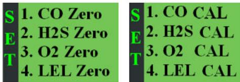
Когда детектор находится в этом интерфейсе, каждое подменю может быть выбрано одноразовым нажатием на кнопку, а для выполнения калибровки нуля или калибровки диапазона нужно дважды нажать на кнопку.
